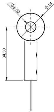
**Accroche du câble de mesure par une tige filetée M4 :**
